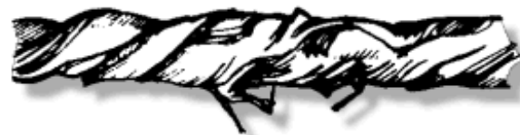
Danneggiamento locale per scarrucolamento o sfregamento contro parti in movimento
