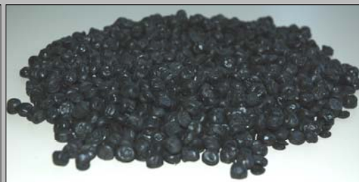
REMIX: Aggregato plastico riciclato espanso
